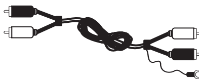
Cinch-Kabel mit zusätzlicher Erdungsklemme
